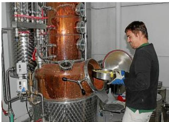
После разбавления водой спирт попадает в сушеварочный котёл (слева). Смесь трав придаёт джину его аромат (справа)
